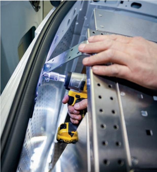
Die Wandbefestigungen müssen so angebracht werden, dass sie gleichermaßen auf Zug und Druck belastet werden. Hat die Einrichtung mehr als 2 Tragrahmen, sind die mittleren Tragrahmen ebenfalls zu befestigen. Verwenden Sie die Spreiznietmutter M6 mit Bund. Es müssen immer jeweils zwei Schrauben am Tragrahmen und an der Karosserie angebracht werden.
