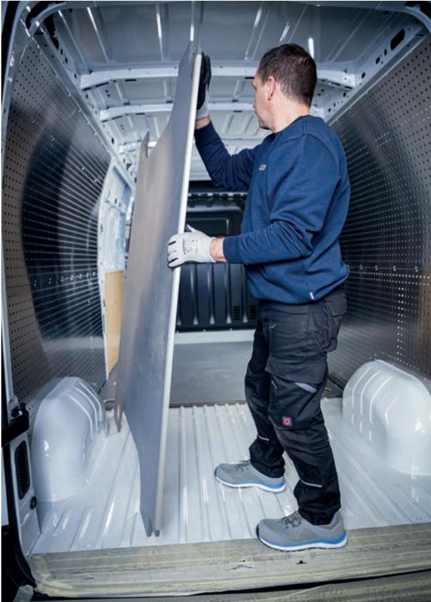
ALUCA Fußbodenplatten werden über die Originalzurrpunkte befestigt. Hierbei ist zu berücksichtigen, dass wir für die Zurrpunkte Kunststoffkomponenten (Topf und Deckel) entwickelt haben, die für alle Fahrzeugtypen verwendet werden.
