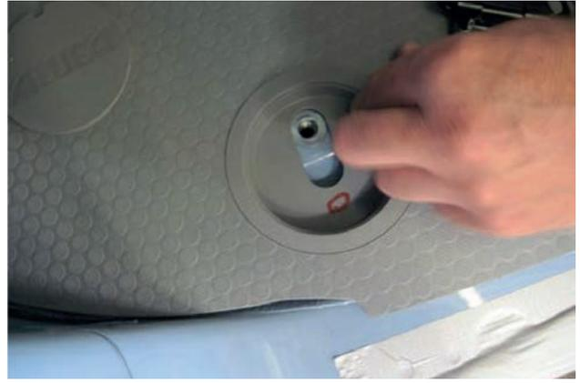
Nachdem der Boden eingelegt wurde, die zweite Bohrung anzeichnen.
