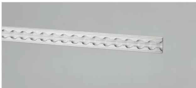
Die Befestigung der Zurrschienen wird bei ALUCA mit M6 Senkschrauben (DIN 7991) der Festigkeit 8.8 und Sicherungsmuttern M6 (DIN 985) oder Spreizmuttern M6 durchgeführt. Bei einem Abstand von ca. 150 mm können wir Auszugswerte von 200 daN gewährleisten. Dies haben wir durch Auszugsversuche in Zusammenarbeit mit dem Hersteller der Zurrschienen nachgewiesen.
