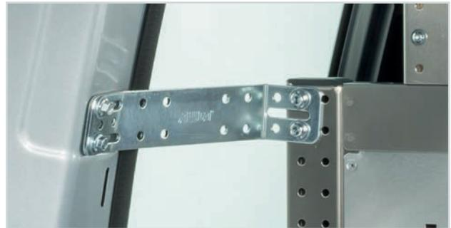
Bitte achten Sie genau auf die Hinweise zum Anbringen der Wandbefestigungswinkel, da diese wichtig sind, um die Einrichtung sicher im Fahrzeug zu befestigen! Schraubverbindungen mit einem Drehmoment gemäß der Drehmomenttabelle (siehe S. 21) anziehen. Schraubverbindungen nach dem Anziehen mit einem Permanentmarker kennzeichnen.
