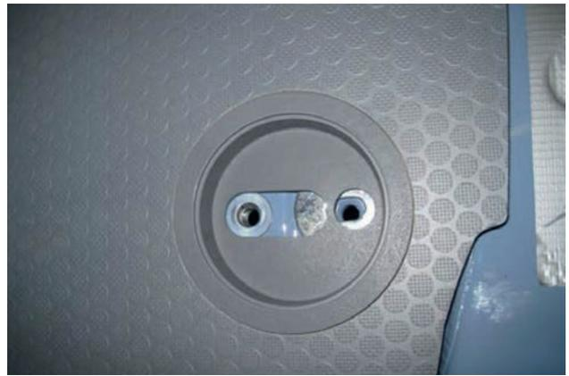
Bohrung mit Stufenbohrer setzen; Ungleichheit mit Karosseriescheibe ( $\varnothing$  20 mm) ausgleichen (nicht im Lieferumfang)
