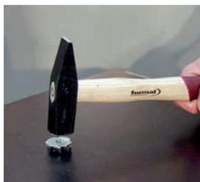
Durchbohren Sie die Bodenplatte von oben mit  $\varnothing$  11 mm. In die Bohrungen werden die Einschlagmuttern M8 von unten eingebracht.
