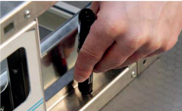
Markieren Sie die Befestigungspunkte mit denen das Gehäuse und die Bodenplatte verschraubt werden.
