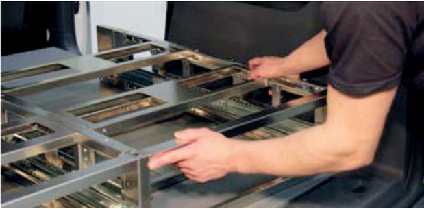
Setzen Sie das Gehäuse in das Fahrzeug und richten Sie dieses auf der Bodenplatte aus.
