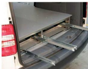
Anschließend verschrauben Sie die Deckplatte mit dem Gehäuse (Senkschrauben).
