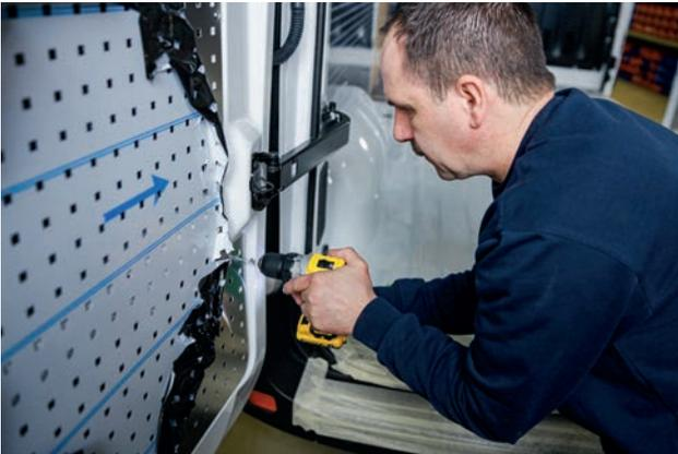
Die Seitenwandverkleidungen werden passgenau für Ihr Fahrzeug geliefert. Wir empfehlen Ihnen Filzstreifen auf die Rückseite der Seitenwandverkleidung zu kleben oder Silikon aufzutragen, um gelegentlich auftretende Geräusche durch Vibrationen zu vermeiden. Die Befestigung erfolgt mit selbstschneidenden Blechschrauben an den Holmen des Fahrzeugs.
