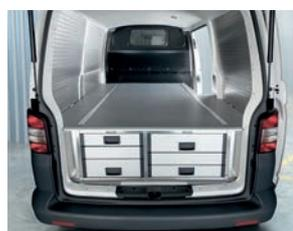
Führen Sie die Schubladen wieder mit den Laufschiennen in die Gehäuse ein und befestigen Sie diese.
