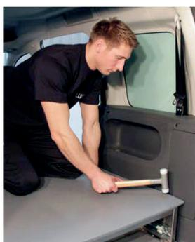
Markieren Sie die Befestigungspunkte des Gehäuses zur Deckplatte und stecken Sie die mitgelieferten Körner in die vorgesehenen Löcher  $\varnothing$  6mm. Legen Sie die Deckplatte auf und kören diese an.
