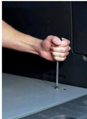
Markieren Sie die Befestigungspunkte der Bohrungen mit denen die Bodenplatte und die Karosserie verschraubt werden.
