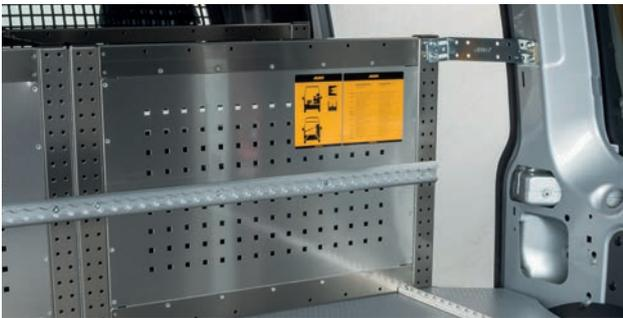
Jeder fertig montierten Einrichtung werden unsere Belastungsaufkleber beigelegt. Bringen Sie diese gut sichtbar an der Einrichtung oder am Fahrzeug an. Die Aufkleber geben Auskunft darüber, wie unsere Produkte und Zurrpunkte, die durch uns nachgerüstet wurden, belastet werden dürfen.
