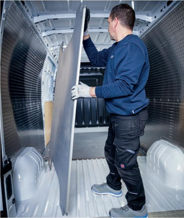
ALUCA Fußbodenplatten werden über die Originalzurrpunkte befestigt. Hierbei ist zu berücksichtigen, dass wir für die Zurrpunkte Kunststoffkomponenten (Topf und Deckel) entwickelt haben, die für alle Fahrzeugtypen verwendet werden.
